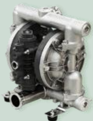
D250S-F-X FDA級 電拋光不鏽鋼泵 1½" 衛生法蘭連接口 190 L/min 最大流量（PTFE 膜片） 6.5mm 最大粒徑尺寸
